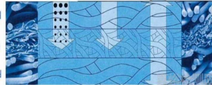
图2: SMS 结构对各种物质阻隔效果示意
